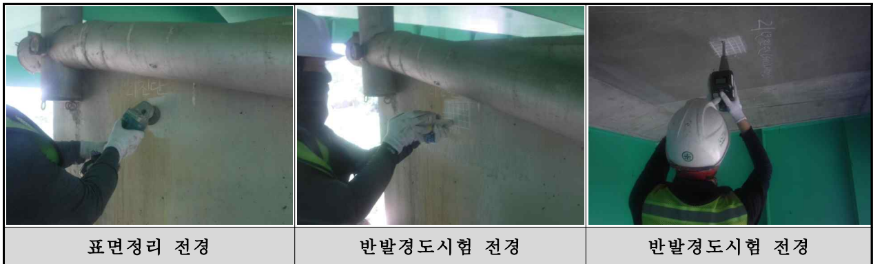
<그림 3.4.1> 상신육교(발안IC방향, 본선) 반발경도시험
