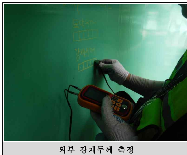
&lt;그림 3.5.15&gt; 강재두께 측정 전경 - 상신육교(향남방향, 램프)
