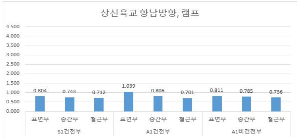
<그림 3.4.40> 염화물 함유량 시험결과 - 상신육교(향남방향, 램프)
