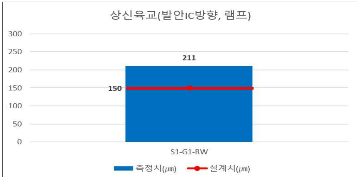
&lt;그림 3.5.9&gt; 도막두께 측정 결과-상신육교(발안IC방향, 램프)
