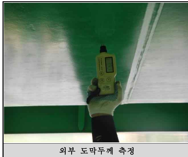
<그림 3.5.4> 도막두께 측정 전경 - 상신육교(발안IC방향, 본선)
