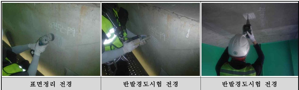
&lt;그림 3.4.24&gt; 상신육교(향남방향, 본선) 반발경도시험
