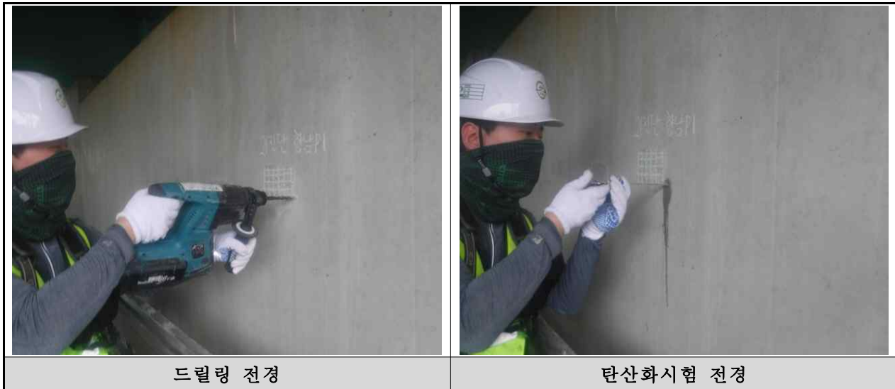
<그림 3.4.29> 상신육교(향남방향, 본선) 탄산화시험 전경
