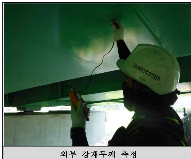
&lt;그림 3.5.2&gt; 강재두께 측정 전경 - 상신육교(발안IC방향, 본선)
