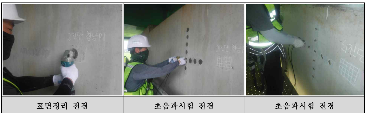
&lt;그림 3.4.27&gt; 상신육교(향남방향, 본선) 초음파시험 전경
