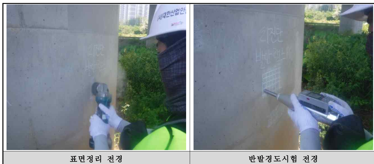
&lt;그림 3.4.14&gt; 상신육교(발안IC방향, 램프) 반발경도시험
