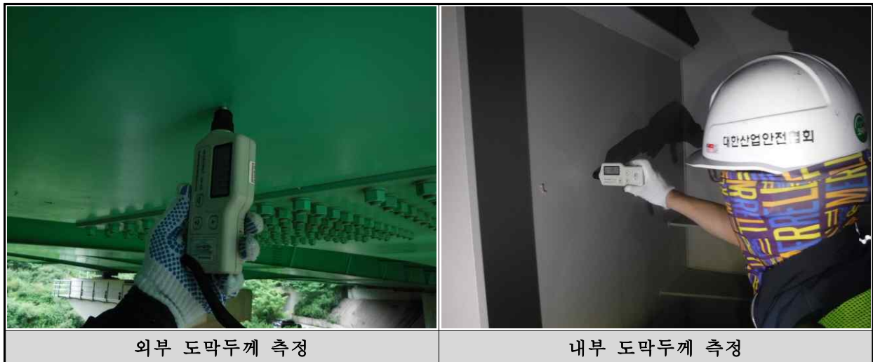
<그림 3.5.13> 도막두께 측정 전경 - 상신육교(향남방향, 본선)
