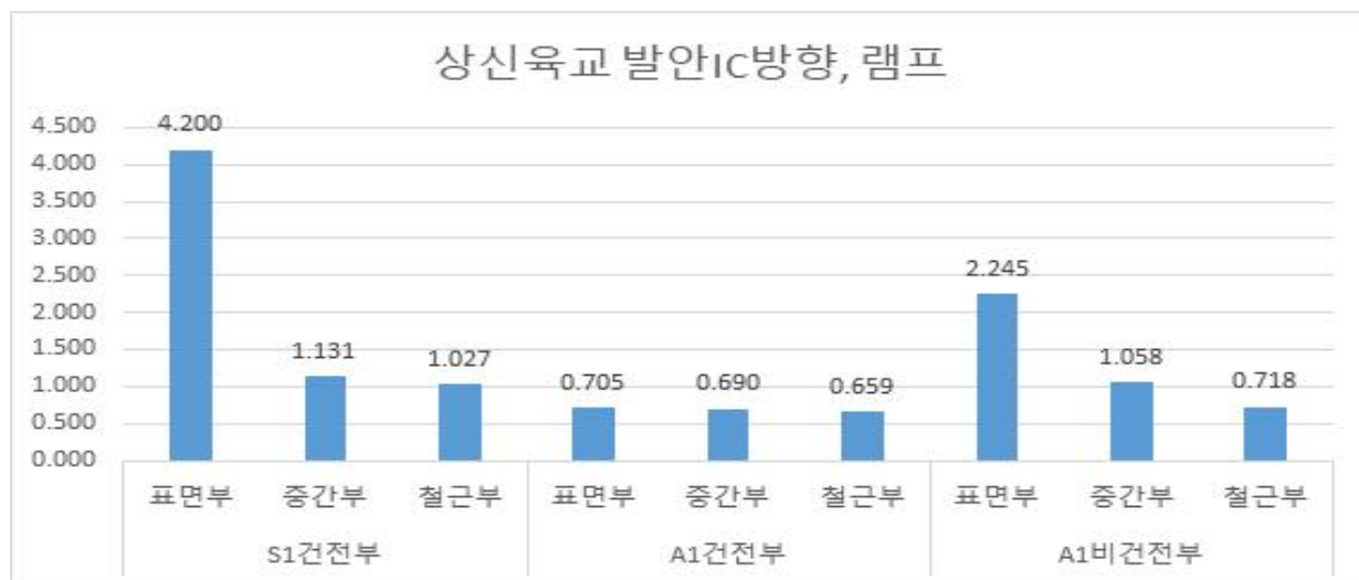
<그림 3.4.21> 염화물 함유량 시험결과-상신육교(발안IC방향, 램프)
