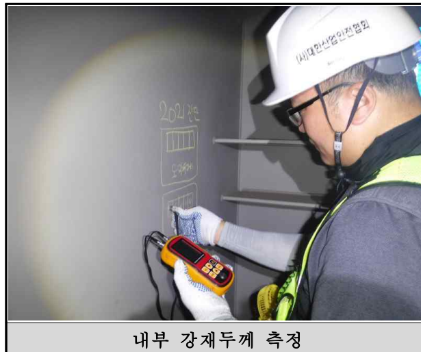
&lt;그림 3.5.6&gt; 강재두께 측정 전경 - 상신육교(발안IC방향, 램프)
