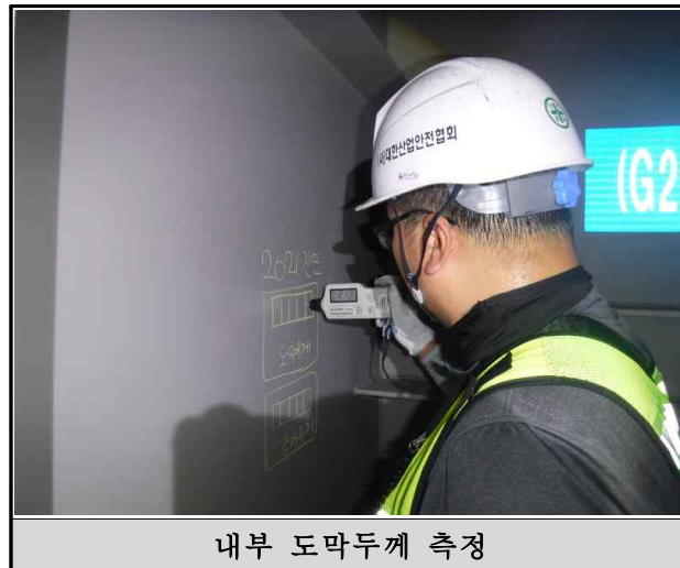
&lt;그림 3.5.8&gt; 도막두께 측정 전경 - 상신육교(발안IC방향, 램프)
